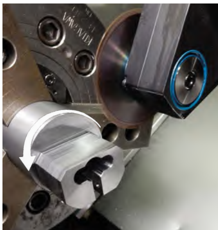
Turn Cut Milling : steel 16MnCrS5 V_c = 160 \text{ m/min} F_z = 0,05 \text{ mm bei } 40 \text{ Zähnen}
